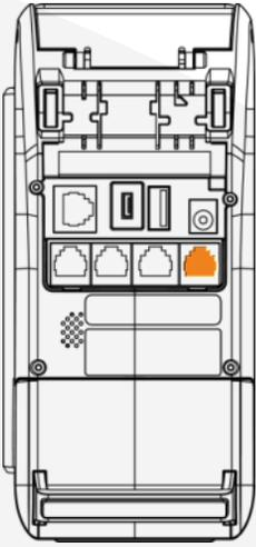
1. Για να ενεργοποιήσετε το PIN Pad συνδέστε το ειδικό καλώδιο της συσκευής στο πίσω μέρος του τερματικού στην ειδική αναγραφόμενη θύρα «PIN Pad»..
